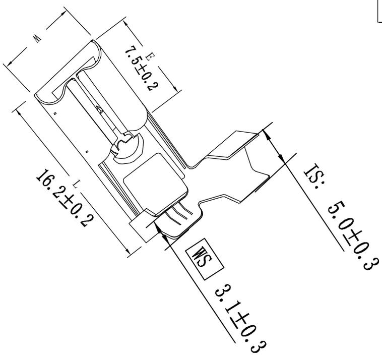
1. 使用温度条件: a. 使用范围温度: -40°~105° C; b. 相对湿度: 15%~95% (温度40° C)
